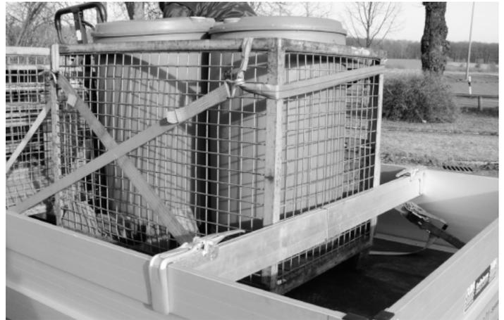
Flüssigkeiten in mobilen Tanks müssen formschlüssig mit dem Fahrzeug verbunden werden. Werden die Tanks in Gitterboxen transportiert, können sie auch durch direktes Verzurren gesichert werden.
